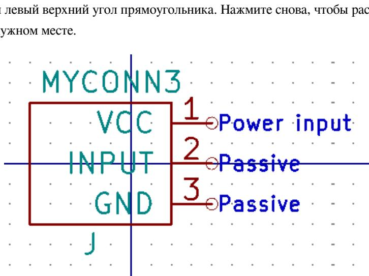
8. Если потребуется закрасить прямоугольник, например, желтым цветом, нужно выбрать его и изменить свойства (клавиша [e]), а именно, установить **Стиль заливки** в **Заливка фона**. Затем в Eeschema открыть **Настройки** → **Параметры редактора схем** → **Цвета** и для **Заливки фона** установить значение *Yellow 4*.
