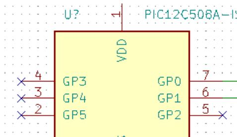
42. Некоторые компоненты имеют невидимые выводы питания. Чтобы сделать их видимыми нажмите на кнопку *Показать скрытые выводы* на левой панели инструментов. Скрытые выводы питания автоматически соединяются с цепями, которые имеют такие же названия, например, *VCC* и *GND*. В общем случае, нужно стараться не выявлять скрытых выводов питания.
