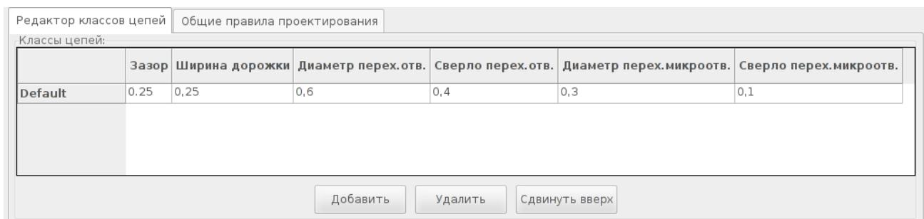
4. Перейдите на вкладку *Общие правила проектирования* и установите *Минимальную ширину дорожки* 0.25. Нажмите кнопку *OK*, чтобы применить внесенные изменения и закрыть окно *Правка правил проектирования*.
