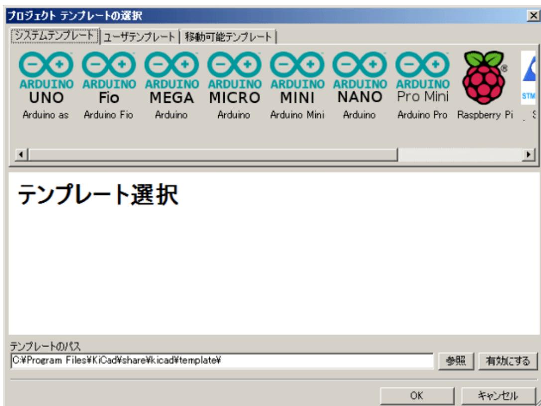
テンプレート・アイコンのシングル・クリックでテンプレートの情報が表示され、更に OK ボタンをクリックすると新しいプロジェクトが作成されます。テンプレート・ファイルは新規プロジェクトの場所へコピーされ、新しいプロジェクトの名前を反映したものへリネームされます。
