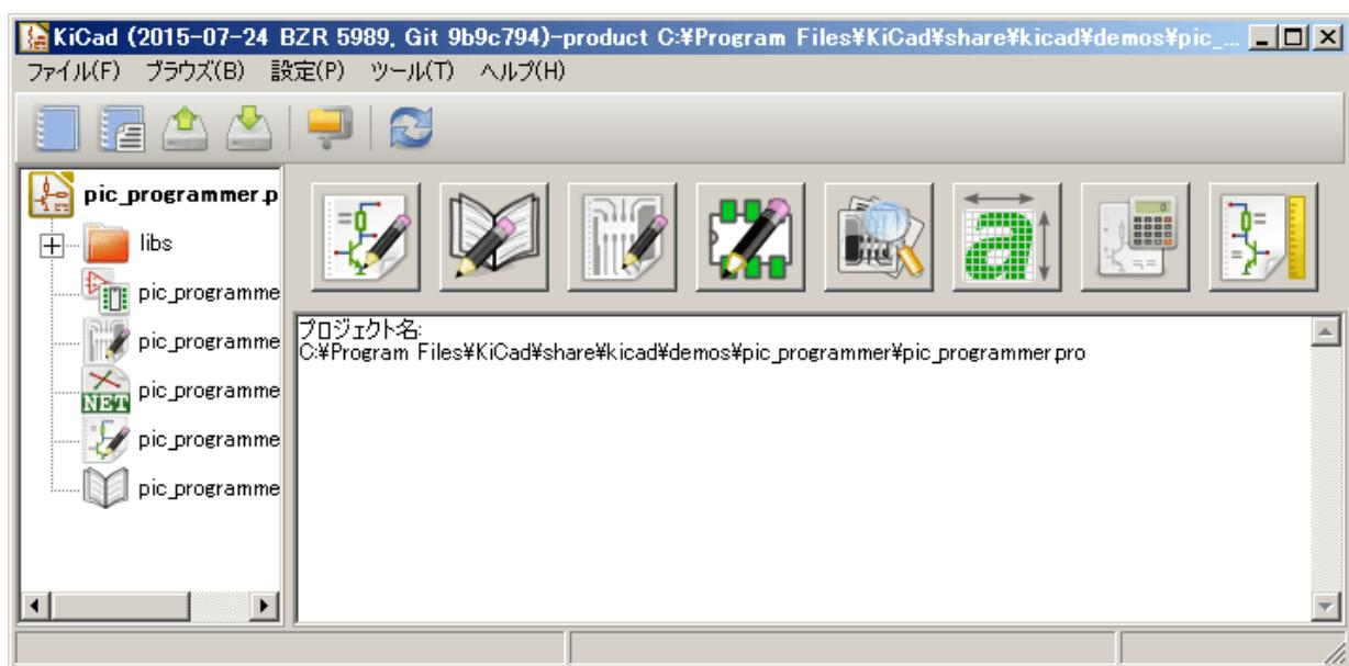
KiCad のメイン・ウィンドウは、プロジェクト・ツリー・ビューおよび、様々なソフトウェア・ツールを起動するボタンのある起動ペイン、そしてメッセージ・ウィンドウで構成されています。メニューとツールバーは、プロジェクト・ファイルの作成、読み込みと保存に使用します。
